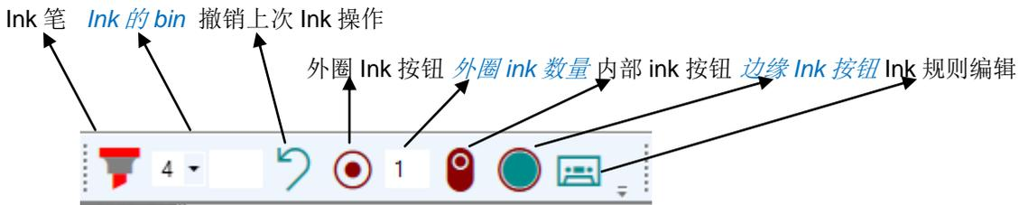
在 WMV 中已经集成了自动 Ink 工具，可以根据设定的规则查找符合规则的聚集 fail 的外圈 Ink 和聚集 fail 的内部 pass 空洞 Ink，还有 Wafer 边缘 Ink。
